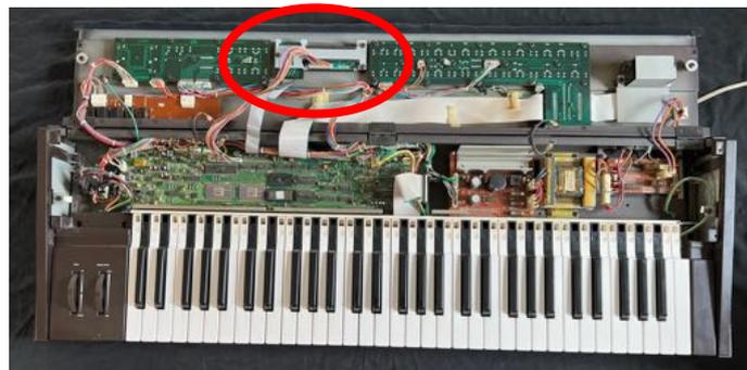
3) Détacher les supports en aluminium d'origine en retirant les vis. Mettez-les supports en aluminium de côté, ils ne serviront plus mais il est toujours bon de garder les pièces d'un instrument vintage. Retirer les deux vis de fixations de l'écran d'origine pour le libérer.
