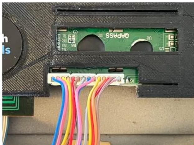
6) Avant de refermer, régler le contraste de l'écran sur le trimpot VR1 de la carte principale avec un petit tournevis. (Rebrancher le DX7 et procéder avec précaution, tension élevée dans la partie PSU).
