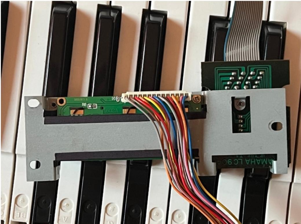
4 ) Le nouvel écran est un peu moins large. Les deux passages de vis ne sont pas alignés. Avec une pince plate tordre légèrement les deux platines de fixation de manière à aligner les deux passages de vis avec le nouvel écran.
