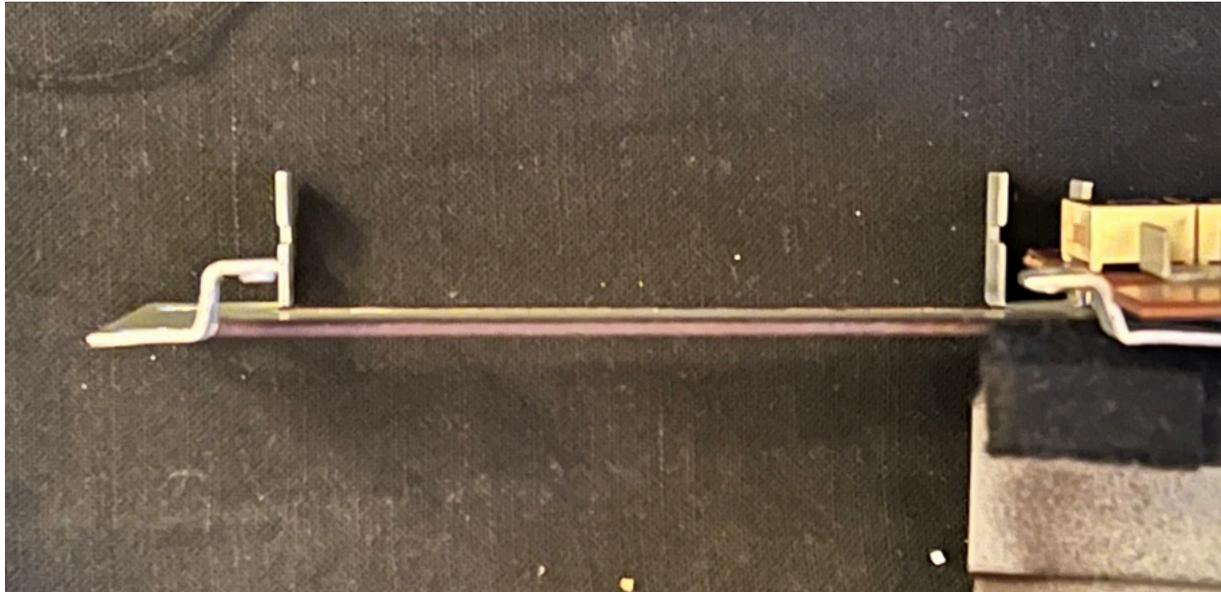
5 ) Remettre les deux vis de fixation sur le nouvel écran, puis replacer l'ensemble dans le support. Les pattes qui enserrant l'écran doivent être légèrement écartées. Fixer l'ensemble avec les 3 vis sans serrer fort, le nouvel écran rétroéclairé est légèrement plus épais. Rebrancher les deux nappes.
