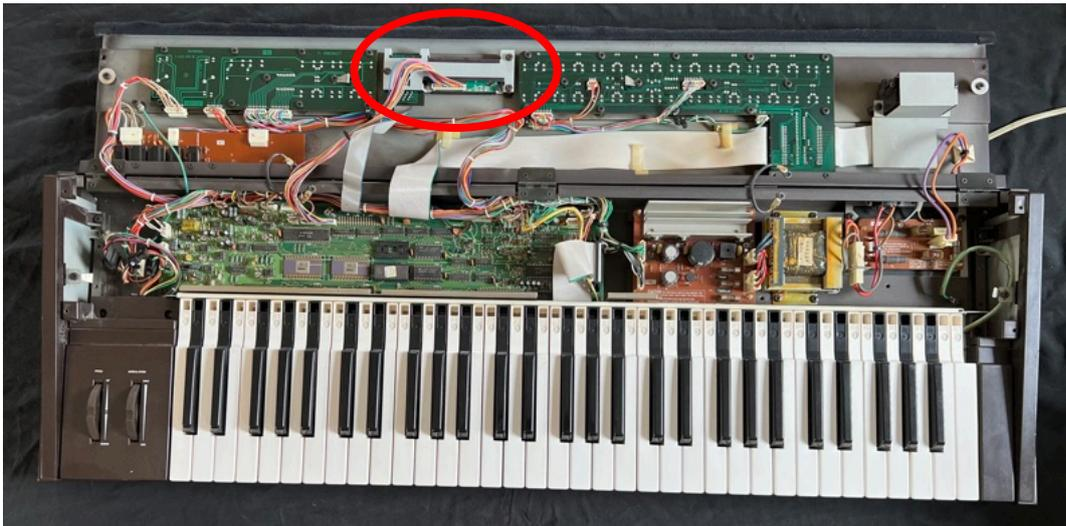
3) Retirer les 3 vis de fixation de l'écran. Débrancher les deux nappes qui relient l'écran à la carte principale. Retirer l'écran original (2vis). Placer le nouvel écran dans le support.
